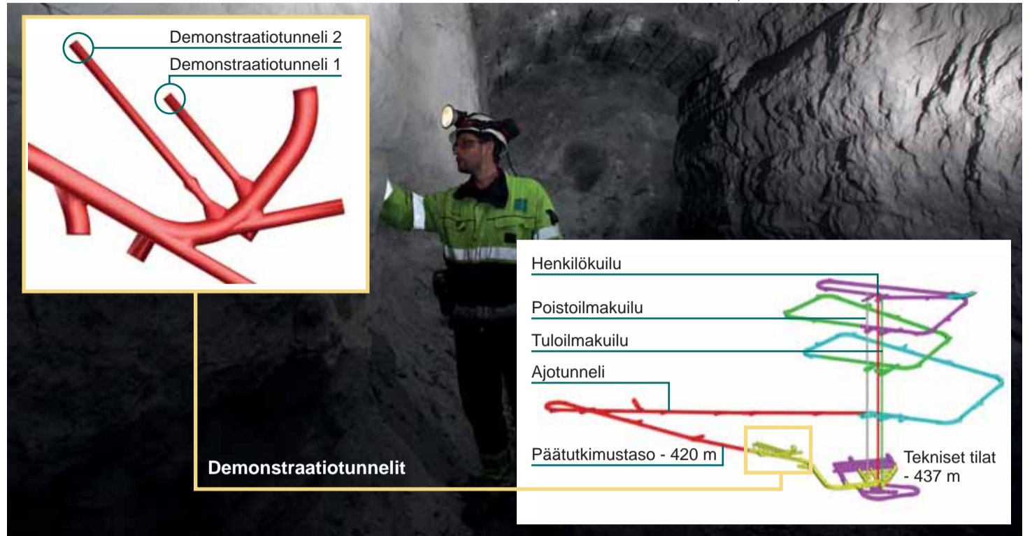
ONKALOon louhittavien demonstraatiotilojen avulla Posiva hakee tietoa loppusijoitustunnelien louhinnasta ja tunneleissa tehtävistä tutkimuksista. Posivan Juha Heine tutkii kalliota Demonstraatiotunneli 1:ssä.
